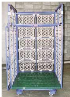
新型ロールボックスパレット。折り畳み式で輸送効率が向上し、省エネルギー効果も高い
