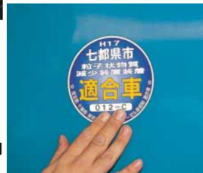
装着後にディーゼル車規制適合車のシールを貼付
