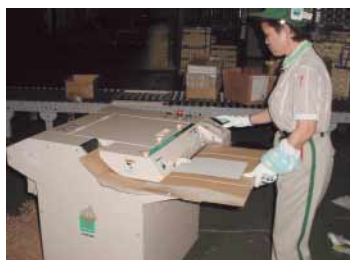
ウェーブクッションによるダンボールの細断
