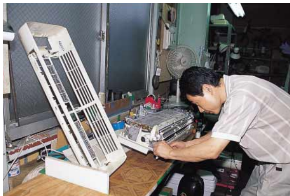
エアコンの分解作業
