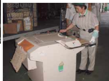
ウェーブクッションによるダンボールの細断
