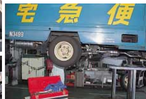
車両のセンターパイプに酸化触媒を追加する
